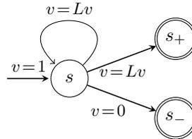
**Figure 1.** Automate calculant la vraisemblance d'une trajectoire
